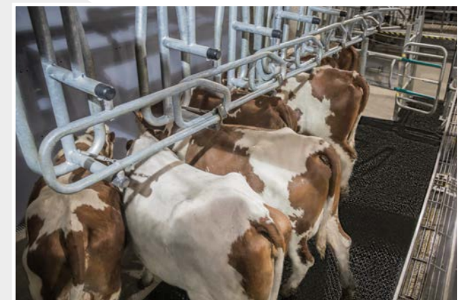
Freier Weg per Knopfdruck: Hebt sich das Ausgangstor auf 1,60 m Höhe, fühlen sich auch große Kühe frei und verlassen sicher den Melkstand.
