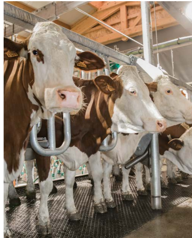
Federkraft bringt die Platzteiler in ihre Ausgangsposition: Im großzügigen Eingangsbereich findet Tier für Tier auf Anhieb seinen Melkplatz.
